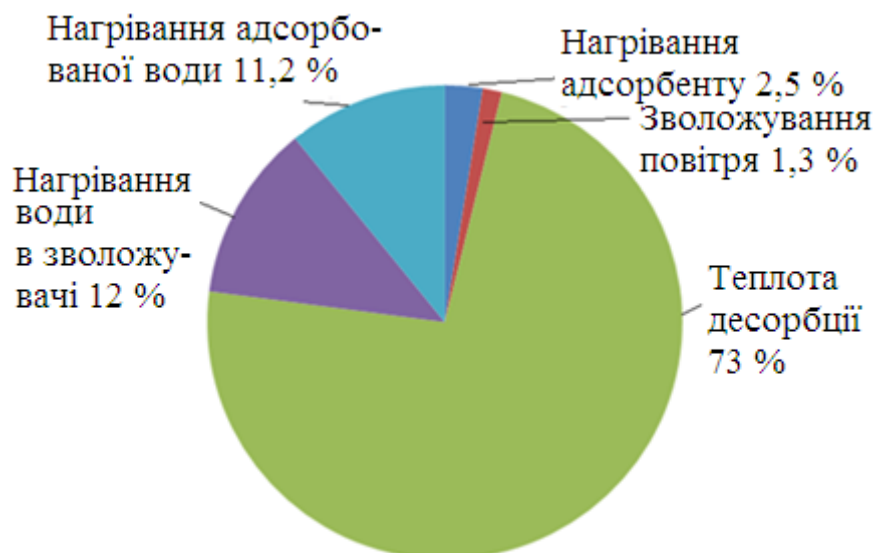
Рис. 3.18. Структура експлуатаційних витрат для теплоакумуючого пристрою відкритого типу при ультразвуковому зволоженні потоку повітря [114, 202].
