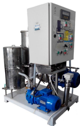
Рис. 3. Дослідна установка нейтралізації конденсату продуктивністю до 450 м 3 /год Fig. 3. Installation for neutralization of condensate with a productivity of up to 450 m 3 /h
