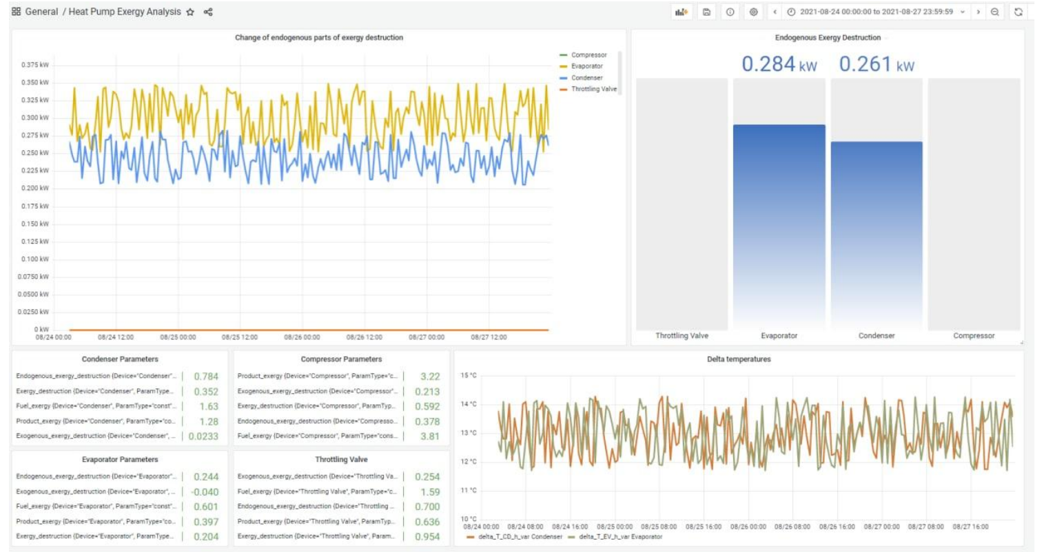
Приклад приладової панелі для діагностики на основі ексергетичного аналізу несправностей у тепловому насосі
