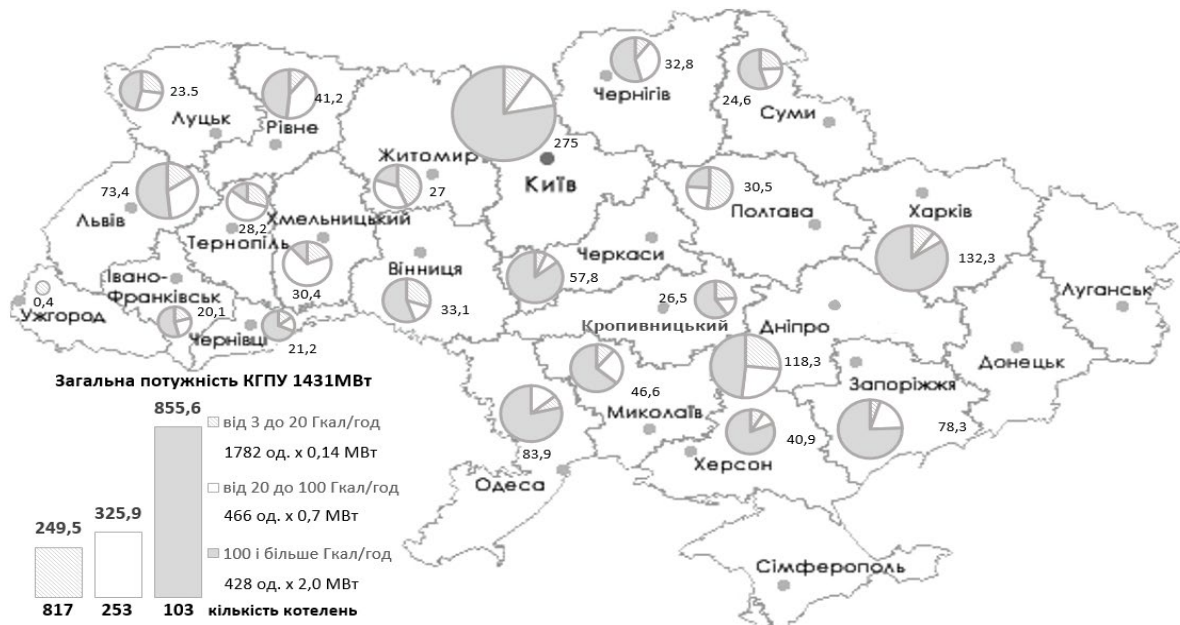
Рис. 3. Електроенергетичний потенціал впровадження КГПУ (кількість та їх електрична потужність) на опалювальних котельнях в обласних центрах України.
