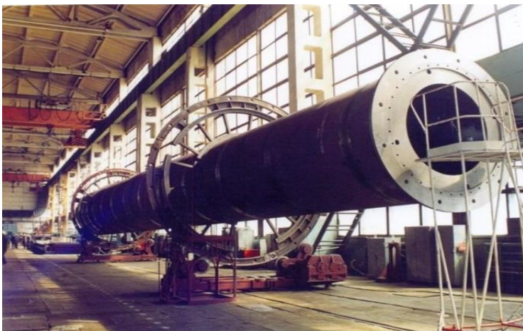
Рис. 2.28. Виробництво веж вітротурбіни Т600-48 на ДП «Виробниче об'єднання Південний машинобудівний завод ім. О. М. Макарова»
