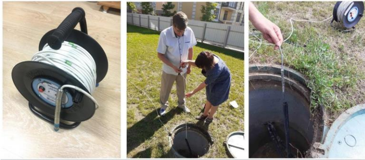
Рис. 6.35. Режимні спостереження у свердловині за допомогою переносного електронного вимірювача рівня води та температури
