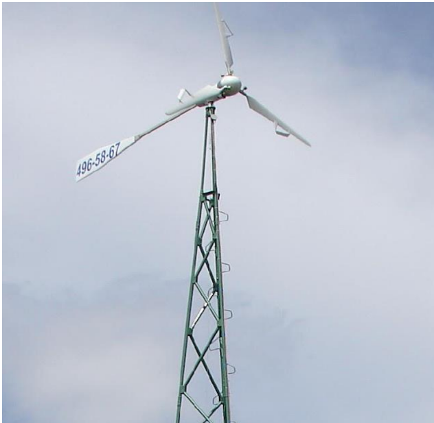
Рис. 2.47. Трилопатєва вітроелектрична установка ВЕУ-08
