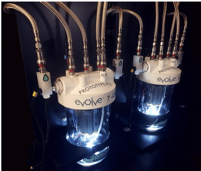
Рис. 8.7. Масштабований електролізер на полімерній основі
