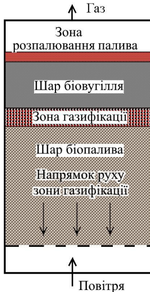
Рис. 4.35. Схема газогенератора оберненого процесу з рухомою зоною газифікації
