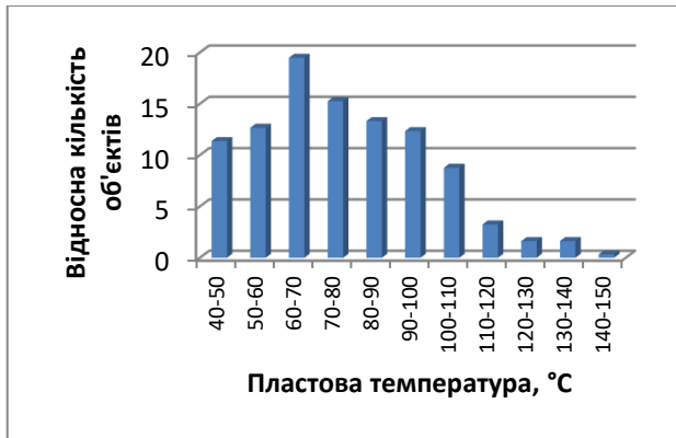
Рис. 6.14. Розподіл пластової температури продуктивних горизонтів у геотермальних об'єктах з електронної бази даних
