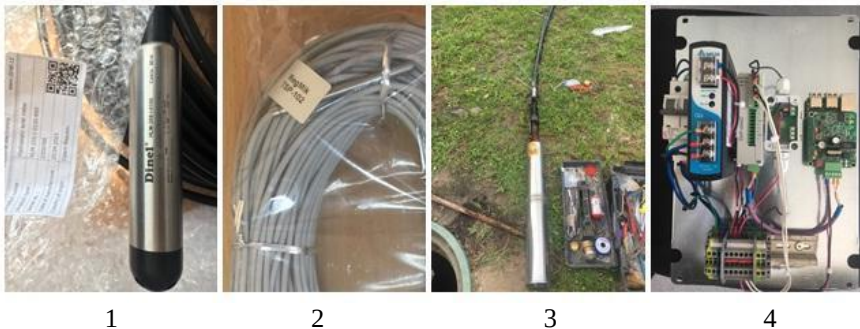
Рис. 6.36. Елементи системи моніторингу параметрів відкачування: 1 – датчик рівня води; 2 – датчик температури; 3 – метод монтажу вимірювальних пристроїв у свердловину; 4 – контролер та прилади зберігання й передавання даних
